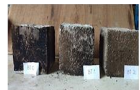
b). Pembakaran bata ringan pada suhu 400°C
