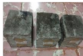
a). Pembakaran bata ringan pada suhu 250°C
