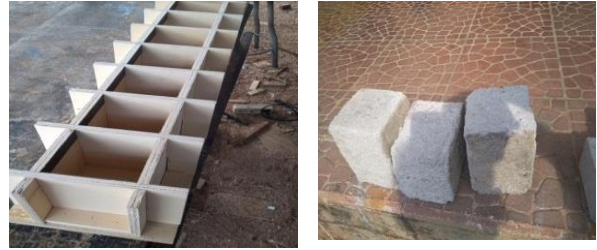
Gambar 1. Cetakan dan hasil cetakan bata ringan Sumber : hasil penelitian
