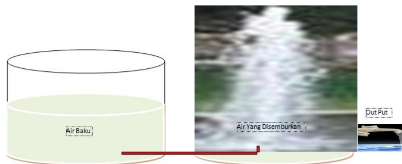
Gambar 1. Skematis Proses Penurunan Kadar Fe Dengan Menggunakan Metode Aerasi di Komplek Asrama Putri Universitas Abulyatama Gampong Lampoh Keude Kecamatan Kuta Baru Kabupaten Aceh Besar
