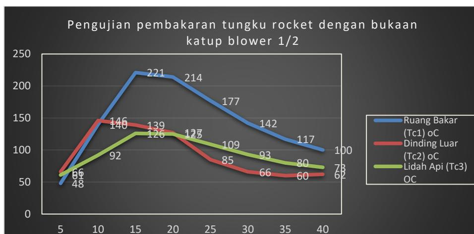
Dari gambar 5 diatas terlihat bahwa profil pembakaran bahan bakar biomassa jenis cangkang sawit pada bukaan katup blower 1/2 ini menghasilkan temperatur 221 °C pada bagian tungku yang berlangsung pada menit ke 15 sampai menit ke 20 setelah pembakaran.
