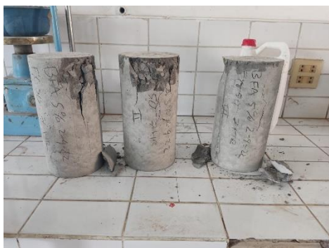
Gambar 3 Beton Yang Hancur Setelah Diuji
