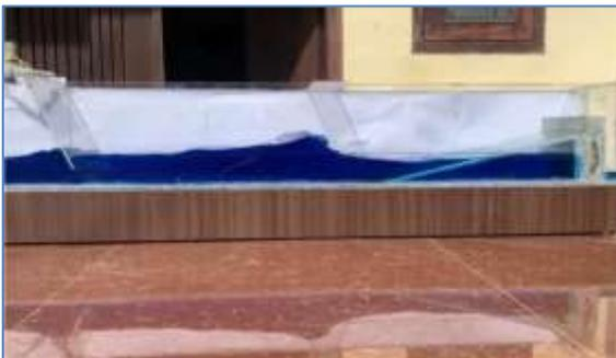
**Gambar 4.** Tinggi Gelombang Maksimum Dengan Model Pelindung Pantai *Seawall*
