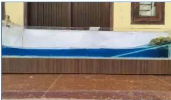
**Gambar 9.** Tinggi Limpasan dengan Model Pelindung Pantai *Breakwater*
