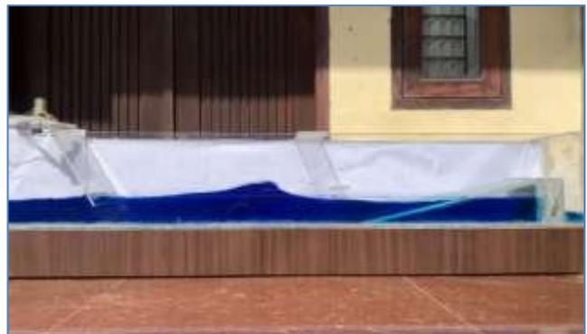
**Gambar 2.** Tinggi Gelombang Maksimum Tanpa Bangunan Pelindung
