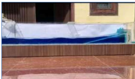
**Gambar 5.** Tinggi Limpasan dengan Model Pelindung Pantai *Seawall*
