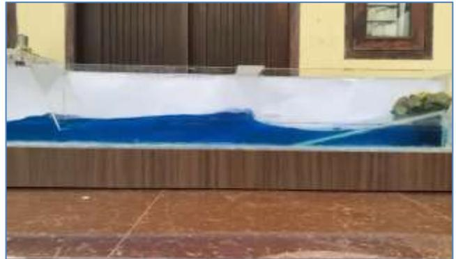
**Gambar 6.** Tinggi Gelombang Maksimum Dengan Model Pelindung Pantai *Revetment*
